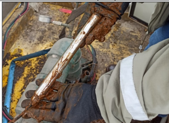
Fotografía 1. Estado de la sonda del dispositivo de monitoreo ubicado en el pozo pz-09-0040.
